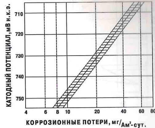
Рис. 2.6. Скорость коррозии стали при различных стационарных потенциалах
