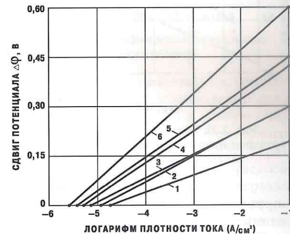
Рис. 2.31. Поляризационные прямые Тафеля, используемые при определении постоянных \alpha и B для грунтов Западной Сибири и Коми АССР:
